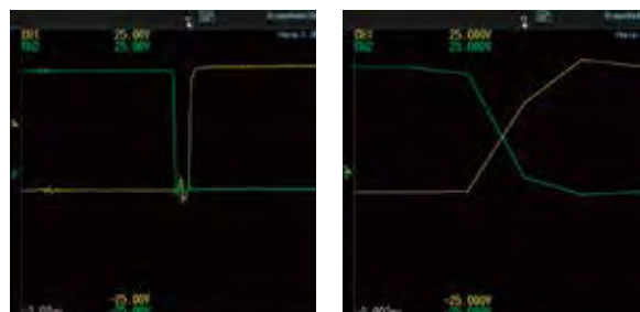
变频器门极信号波形(20kHz)
