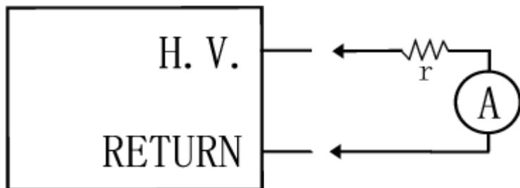
注明:请将电流表接在靠RETURN的端子,以避免电流的读值不准确和电流表意外受损。
