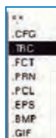
OX7000系列采用的视窗式文件管理，可以保存100多条曲线，几乎无数朵的设置，许多的数学函数以及一系列的截屏（Windows“GIF”格式）。
