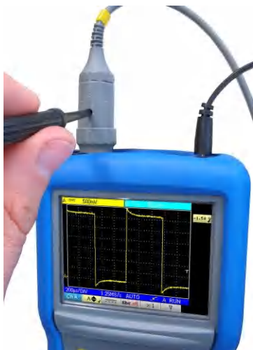
此图例中的示波器传感器有些过补偿且溢出屏幕
