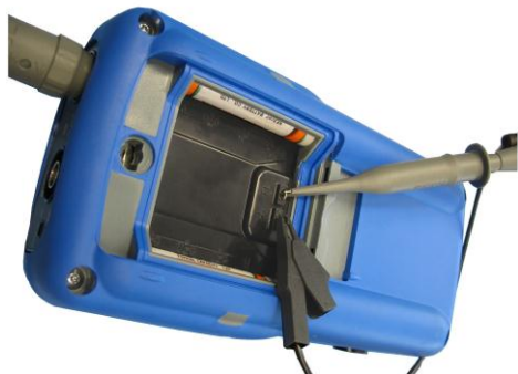
打开电池后仓板后，连接信号测试点进行校准
