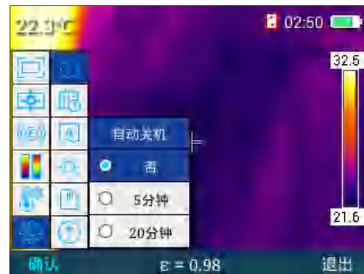
选择“否”表示不自动关机，选择“5 分钟”表示 5 分钟后弹出自动关机提示，若取消则保持开机状态，若无动作则自动关机；同理选择“20 分钟”表示 20 分钟后自动关机。
