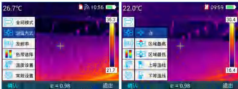
“点”分析模式下测试中心点的温度，如下图所示。
