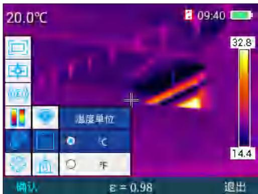
在“报警温度”菜单中按“▶”键进入高温报警、低温报警菜单，此菜单中按“+”“-”号选择高温报警或者低温报警，此时选择的区域会蓝色高亮，再按“▶”键出现加减号，按“+”或者“-”键对报警温度值进行温度数值调节，高温报警温度时在区域分析中对于大于此设置的温度值蓝黑色十字光标会不停闪烁进行光标报警，低温报警温度时在区域分析中对于小于此设置温度值蓝黑色十字光标不停闪烁进行光标报警。按“确认”键保存当前设置的值，按“◀”键退回上一级菜单。按“退出”键退出此菜单回到主菜单目录。如下图所示。
