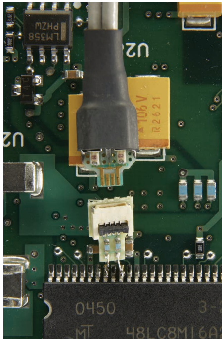
焊接在电路板上的 InfiniiMax ZIF 探针
