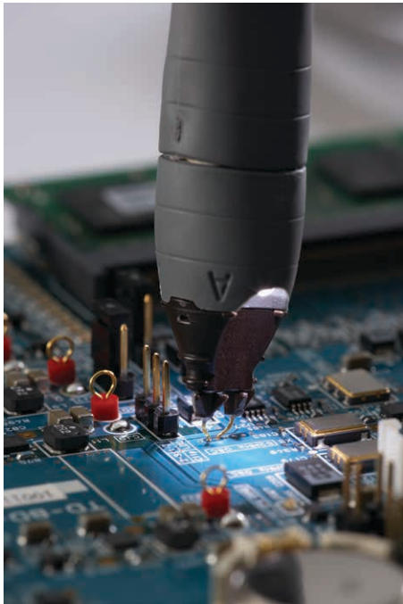
配有点测式探针的 N2750A
