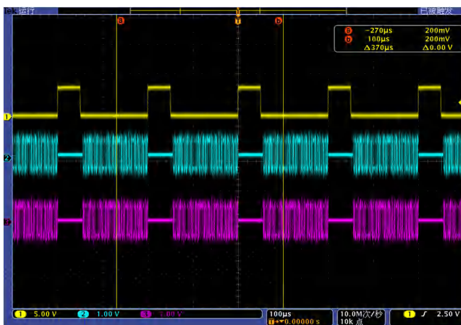
图 4.26 基带触发示意图（门控 低有效）
