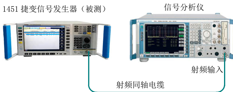
图6.10 I/Q矢量调制功能测试
