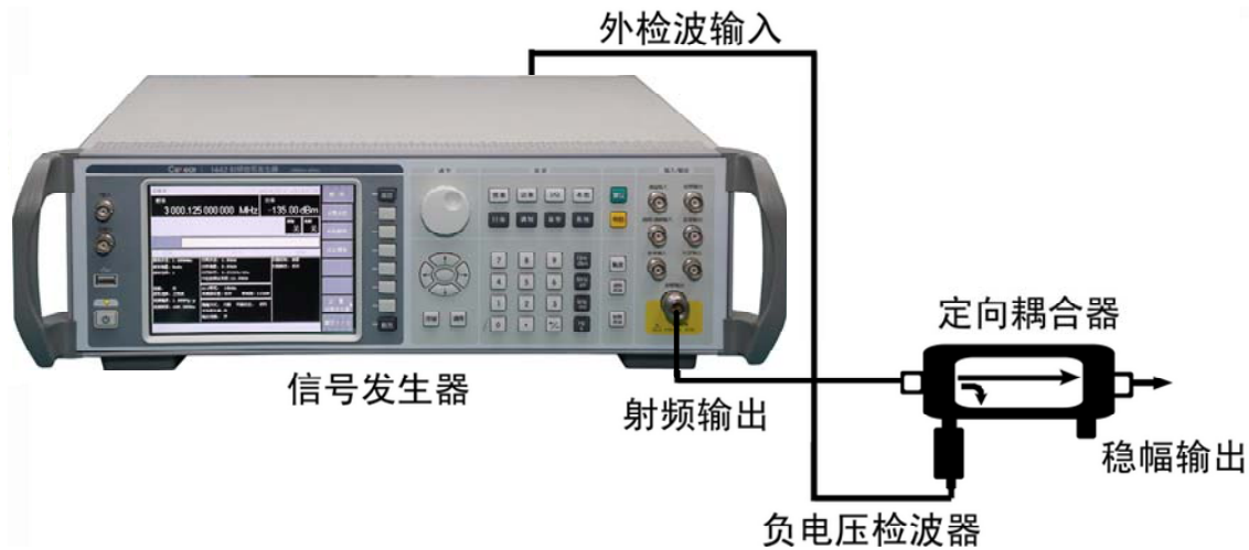
图 6-3 ALC 电路外部稳幅
