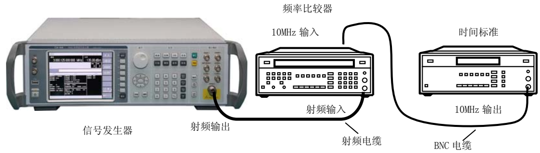
图 10-4 内部时基老化率测试
