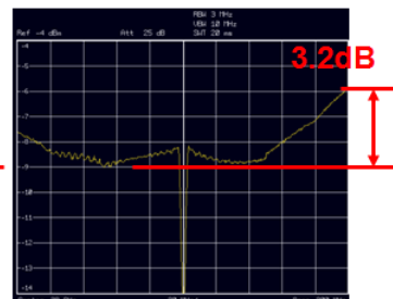
载波 5.5GHz 200MHz调制带宽: 3.2dB
