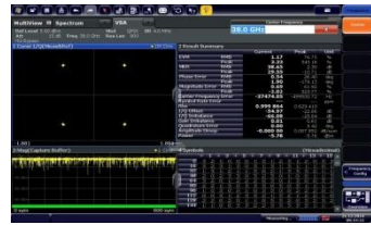
载波 38GHz EVM(% RMS): 1.2% 原点偏移: -55dBc (码元速率 4Msps)
