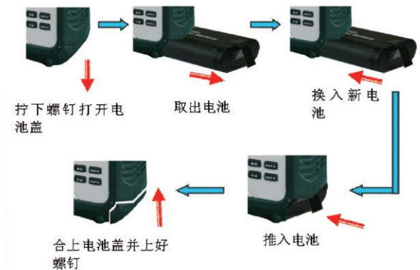
图6 电池更换示意图
