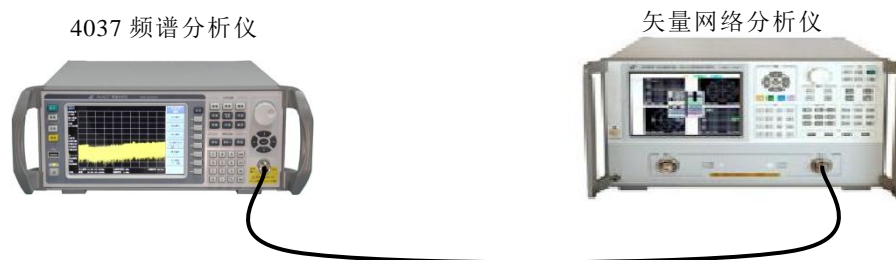
图 14 输入端口电压驻波比测试设备连接
