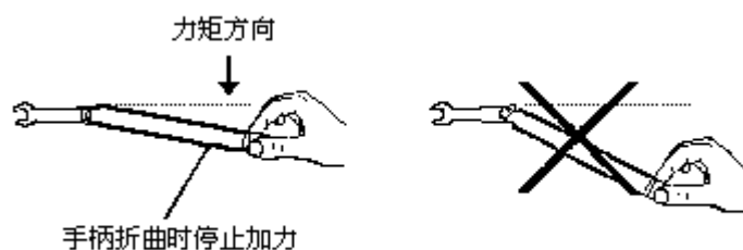
图 2-6 力矩扳手的使用方法
