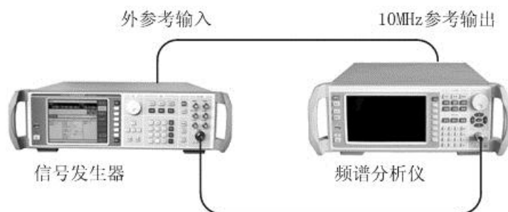
图 3-8 应用频率计数功能测试信号频率的设备连接图
