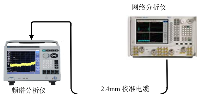
图 11-18 输入端口电压驻波比测试
