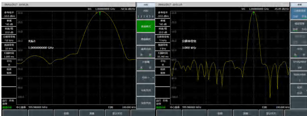
图 4-11 使用噪声光标功能测量噪声
