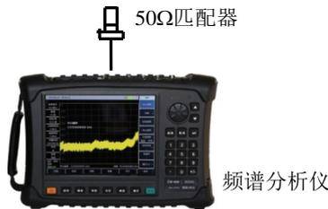
图 13-8 显示平均噪声电平测试设置
