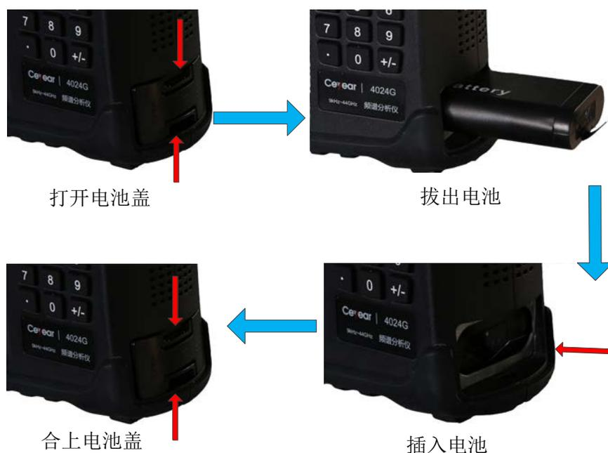
图 2-1 安装及更换电池步骤
