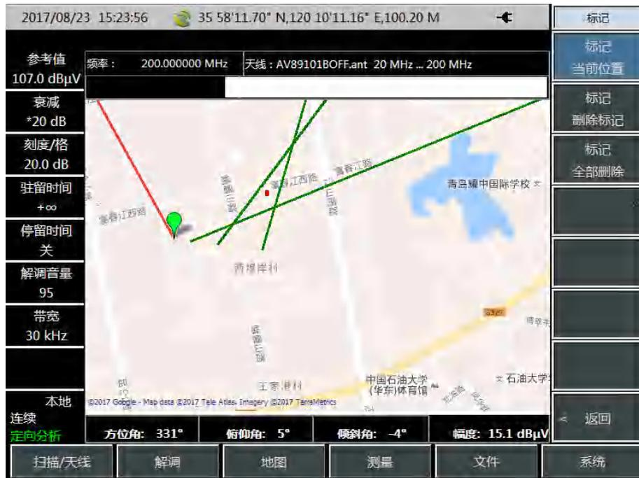
图 10-3 地图测量模式示意图
