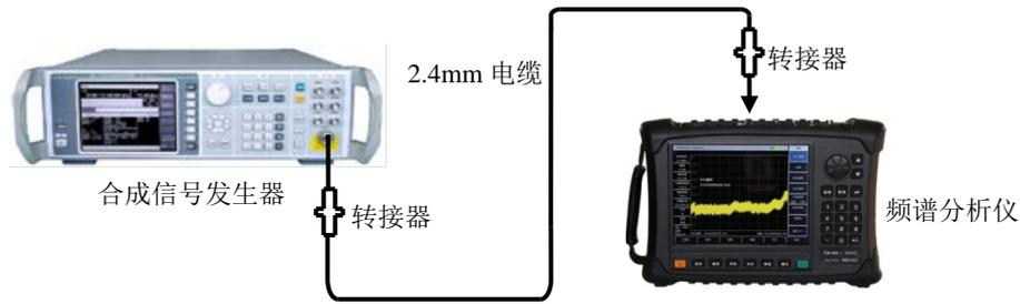
图 13-2 频率读出准确度测试框图
