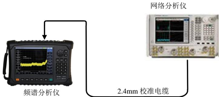
图 13-18 输入端口电压驻波比测试
