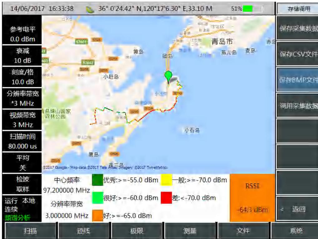
图 4-28 干扰地图 RSSI 测量示意图
