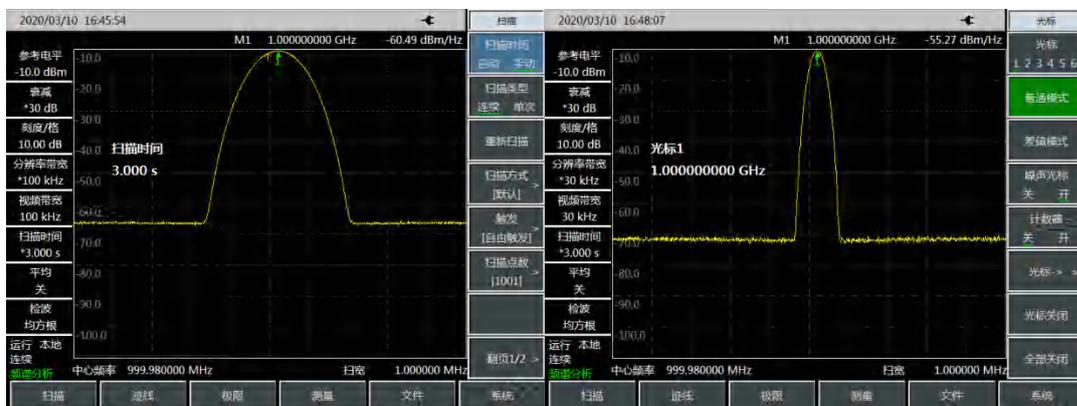
图 4-11 使用噪声光标功能测量噪声
