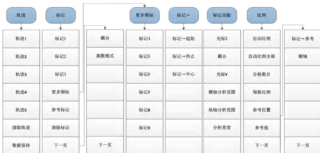
图 5.9 频率功率菜单结构图二层
