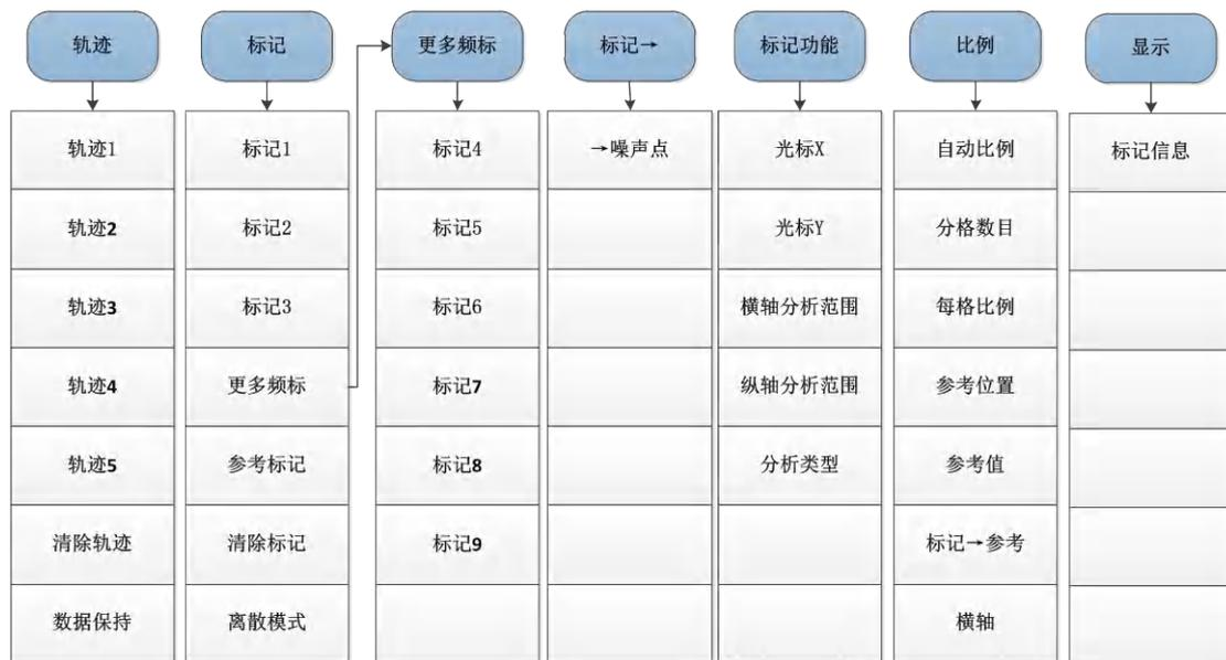
图 5.19 基带噪声菜单结构图二层
