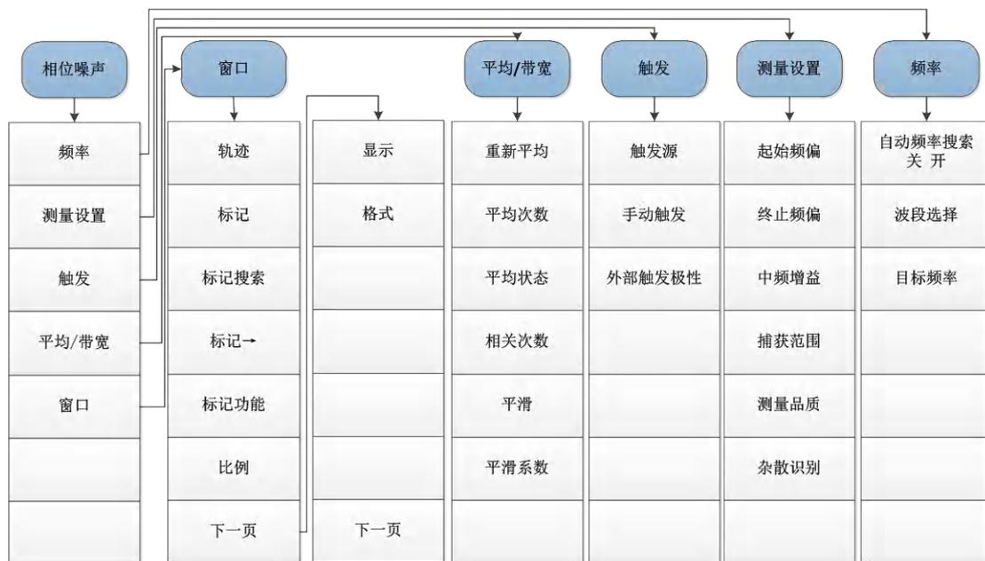
图 5.2 相位噪声菜单结构图一层
