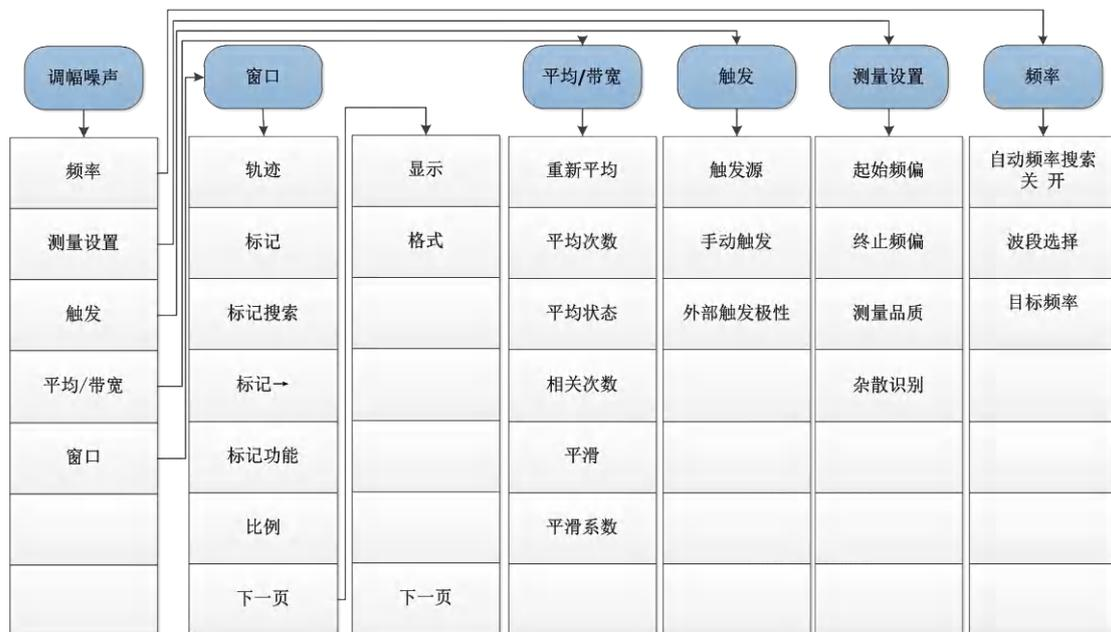
图 5.15 幅度噪声菜单结构图一层
