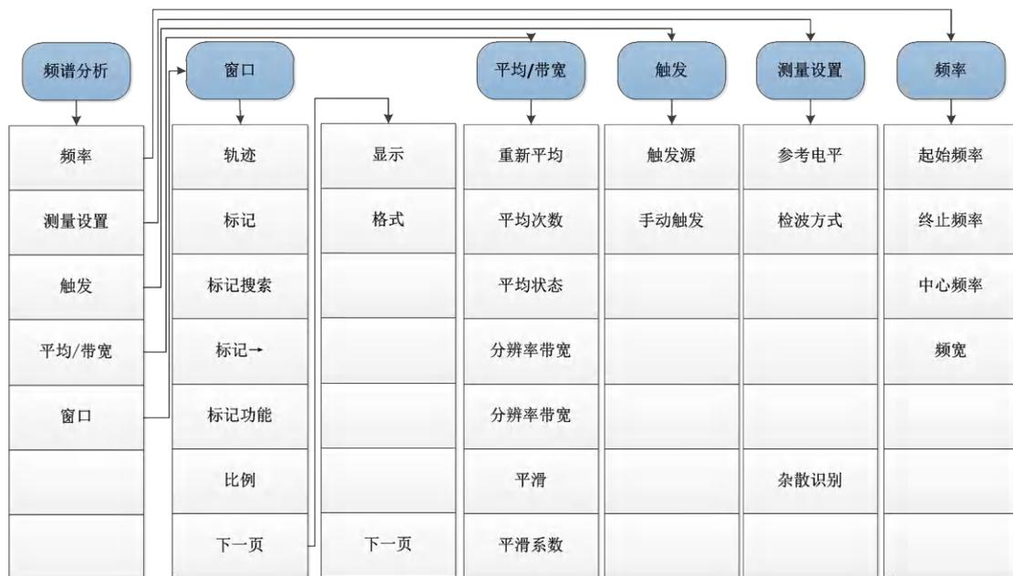
图 5.5 频谱分析菜单结构图一层
