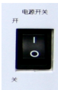
图 2-2 频谱分析仪后面板电源开关
