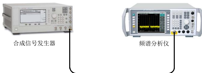
图 6-6 噪声边带测试设置
