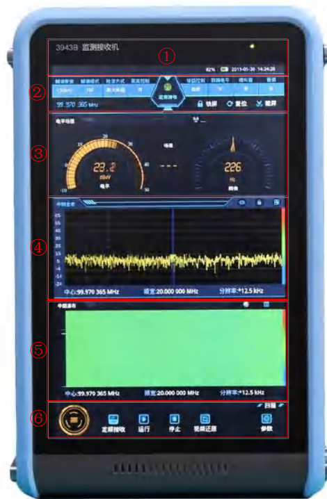
图 3.10 3943B 监测接收机前面板
