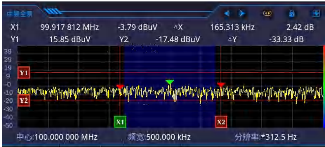
图 5.25 中频全景窗口频标示意图
