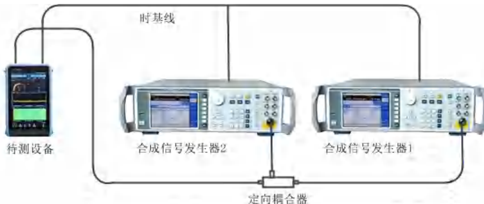
图 8.10 二阶截获点测试示意图
