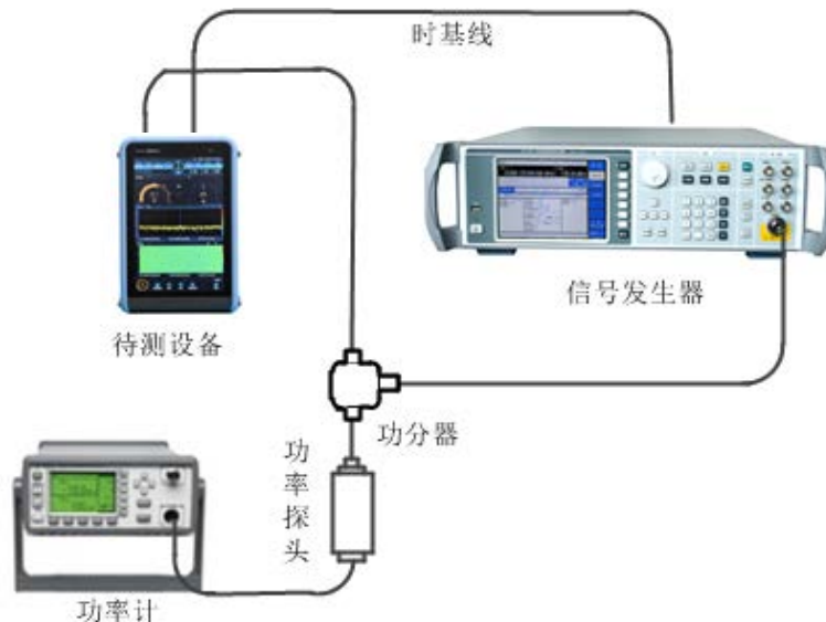
图 8.11 镜频抑制的测试示意图
