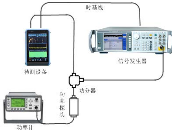
图 8.13 中频抑制的测试示意图
