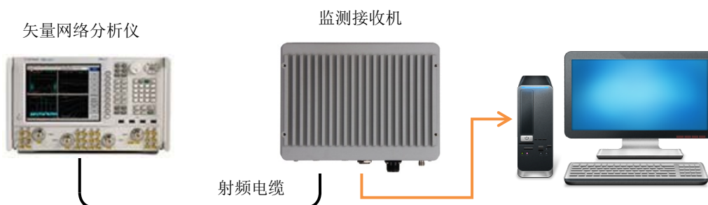
图 10-11 射频输入端口驻波比测试
