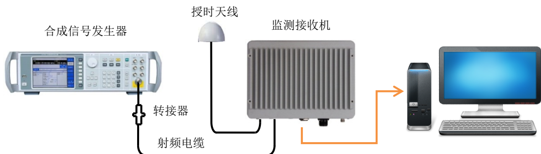
图 10-7 轨迹刷新速度测试
