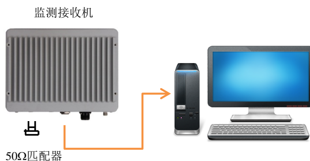
图 10-8 显示平均噪声电平测试
