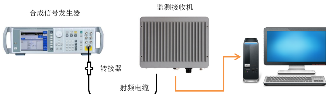
图 10-13 镜像抑制测试
