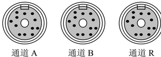
图 3-4 检波器连接端口
