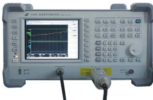
图 2-1 微波噪声系数分析仪外接智能噪声源
