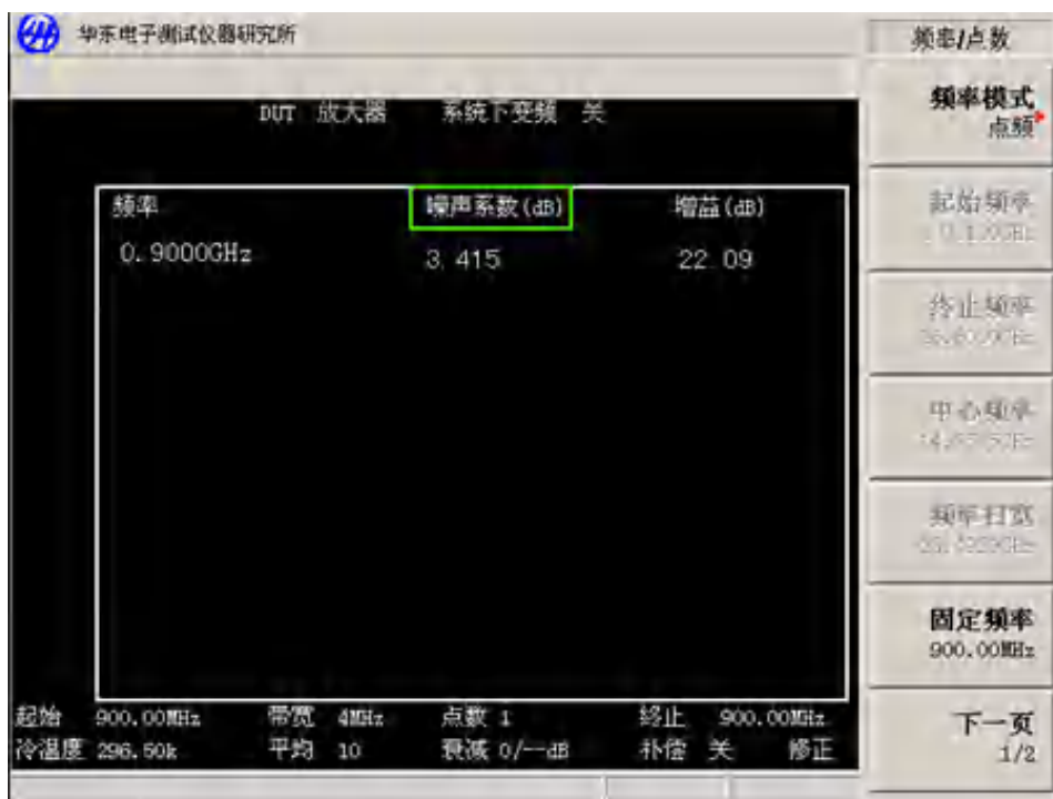
图2-7 测试仪格式显示固定频率测量结果
