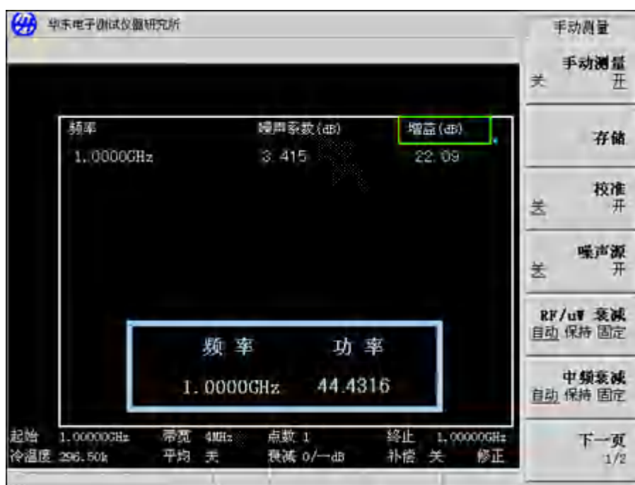
图 4-6 用测试仪格式进行手动测量显示
