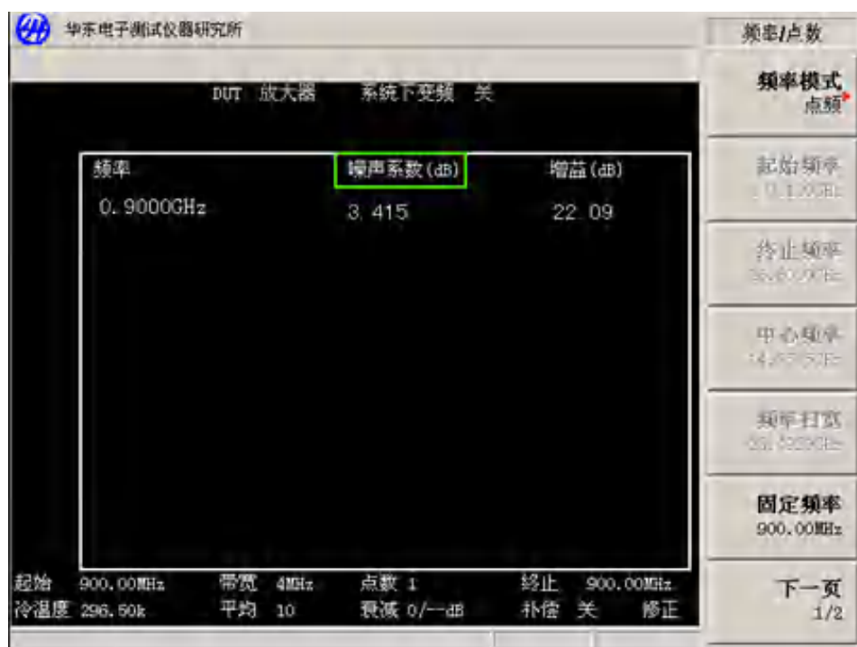
图2-7 测试仪格式显示固定频率测量结果
