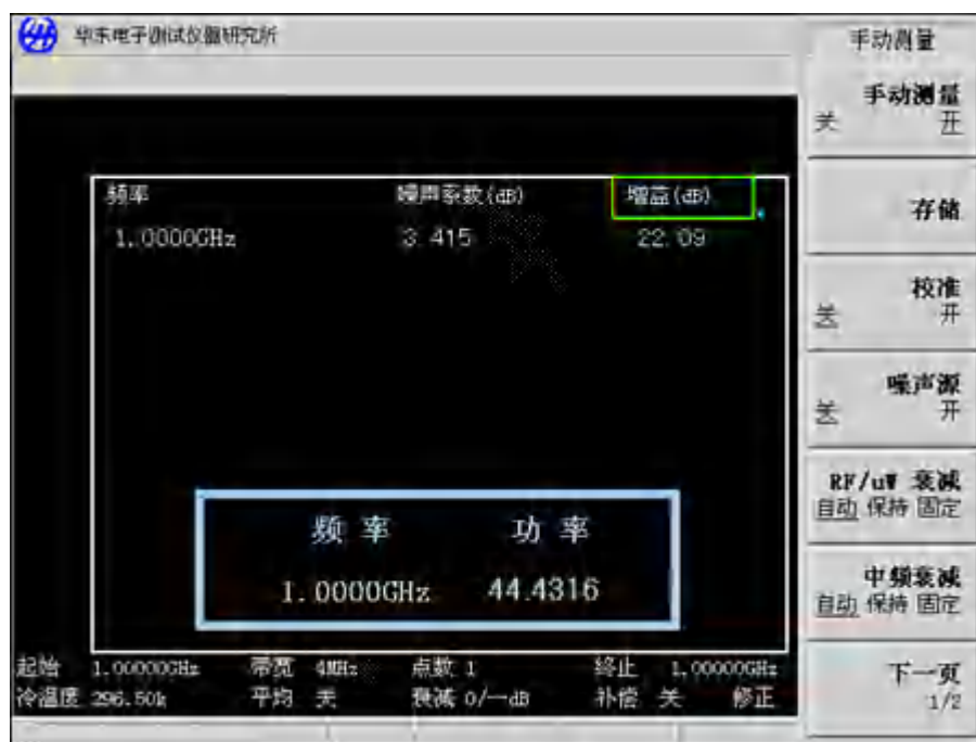
图 4-6 用测试仪格式进行手动测量显示
