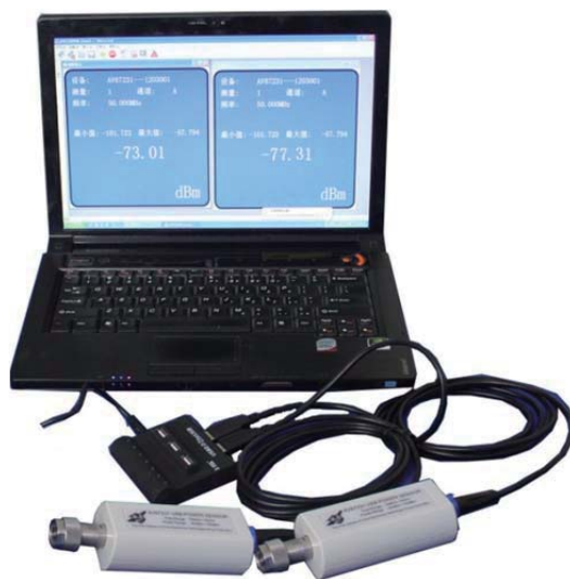
图 4.4 利用 USB HUB 实现多路功率测试
