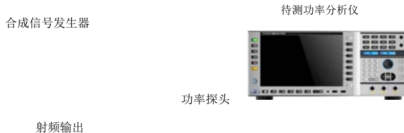
图 8.1 上升时间测试框图
