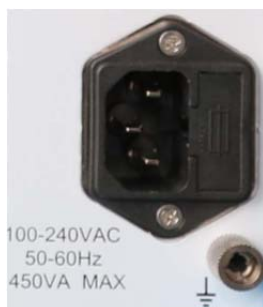
图 3.1 2443A 后面板电源插座
