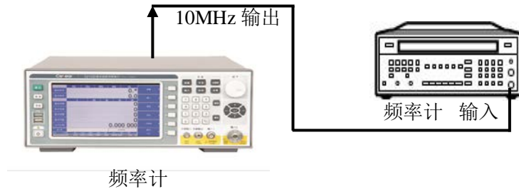
图 8-6 内参考输出频率测试框图
