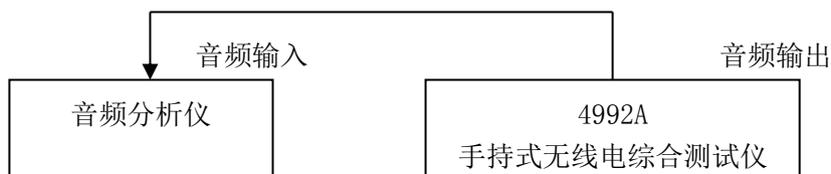
图 7-3 音频源测试连接图
