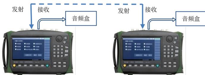
图 4-23 通话连接示意图
