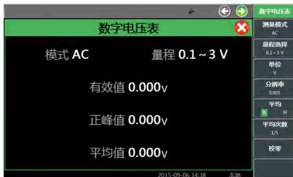
图 4-32 数字电压表显示窗口
