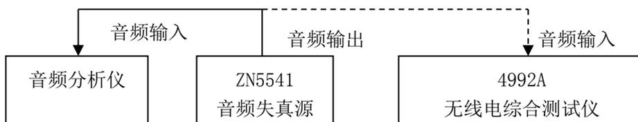
图 7-12 音频失真度测试连接图
