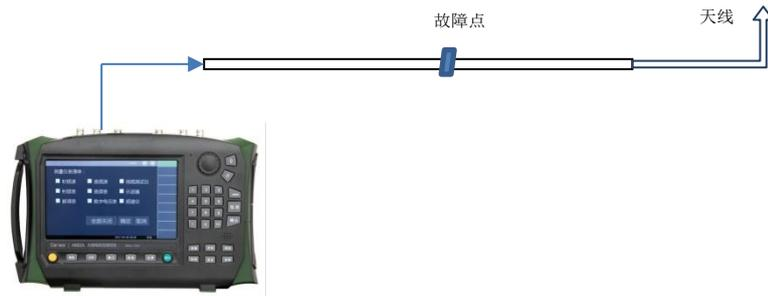
图 4-19 DTF 测量连接示意图
