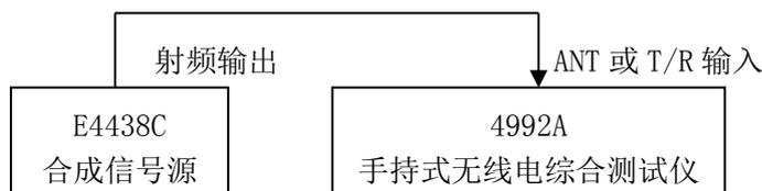
图 7-7 接收信号强度测试连接图
