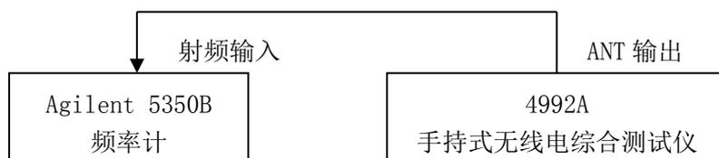
图 7-1 射频源频率范围和分辨率测试框图
