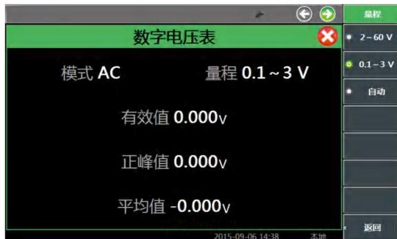
图 4-33 数字电压表量程设置窗口
