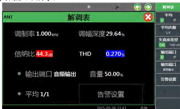
图 4-8 调幅深度测量显示窗口
