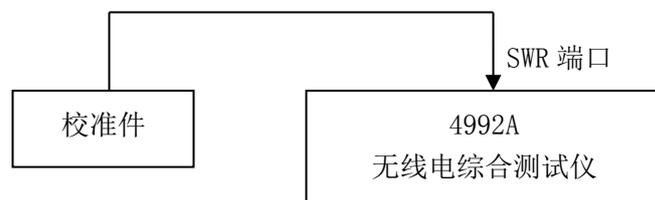
图 7-14 SWR 测量范围测试连接图
