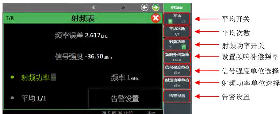
图 4-4 射频功率测量窗口
