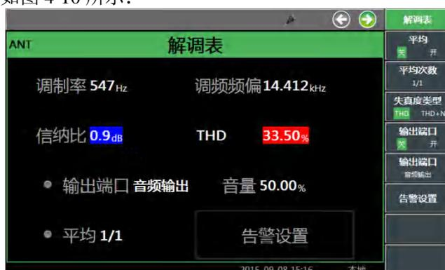
图 4-10 调频频偏测量显示窗口
