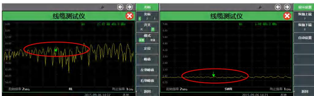
图 4-15 401.2MHz 下回波损耗和驻波比测试图
