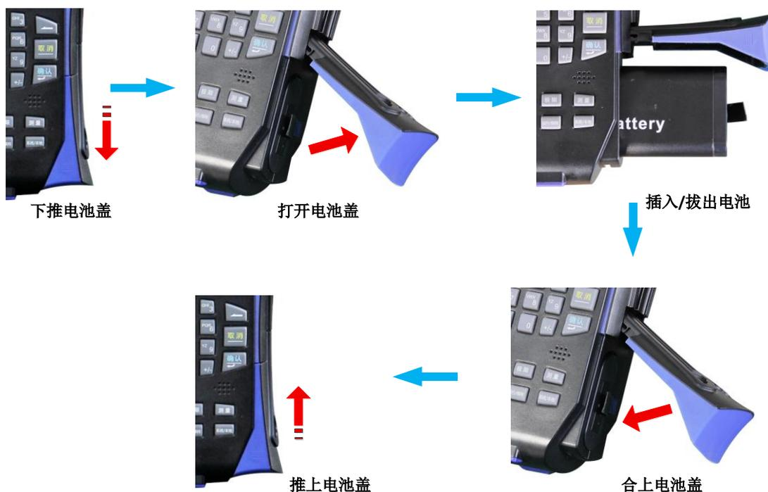
图 2-1 安装及更换电池步骤
