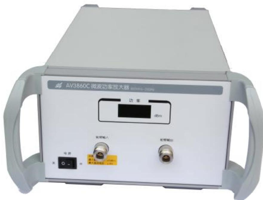
AV3860C 系列宽带微波功率放大器是一种宽带大功率的微波放大器。它具有携带方便、操作简单、频带宽等优点。放大倍数高、输出功率大是它的最大特点。它在 0.8GHz~20GHz 之间，输出功率可以达到 29dBm 以上。
