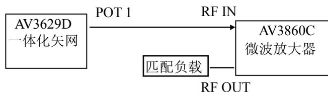
图 5-3 输入电压驻波比测试框图
