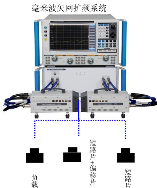
图 9-4 单端口校准连接
