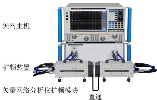
图 9-1 系统动态范围校准测试框图一
