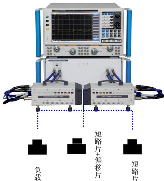
图 9-3 单端口校准连接框图
