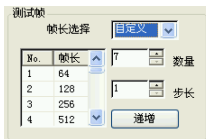
图 3-35 RFC2544 测试测试帧长自定义界面
