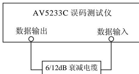
图4-10  $\sqrt{f}$  测试连接图
