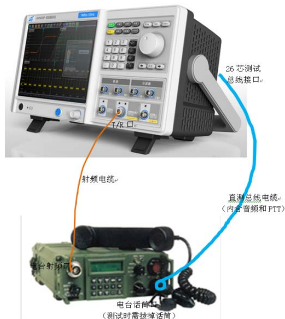
图 6-6 典型的自动测试综测仪与电台连接图
