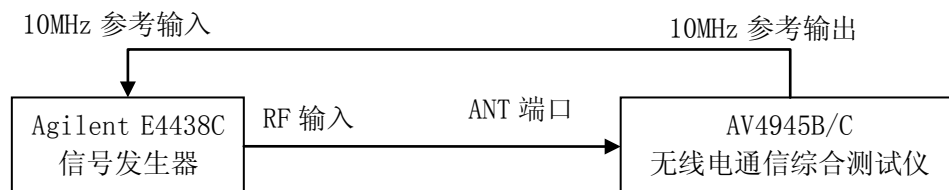
图 6-11 扫频频谱分析特性测试框图
