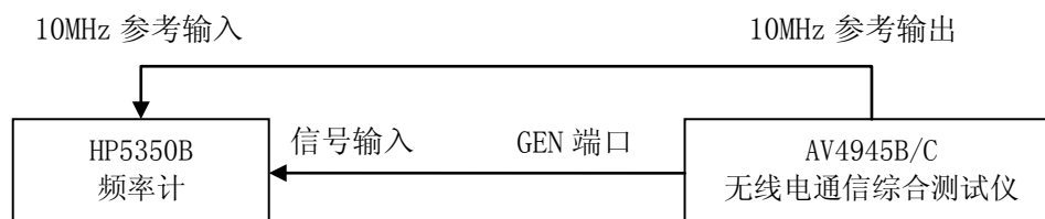
图 6-7 射频信号发生频率特性测试的框图
