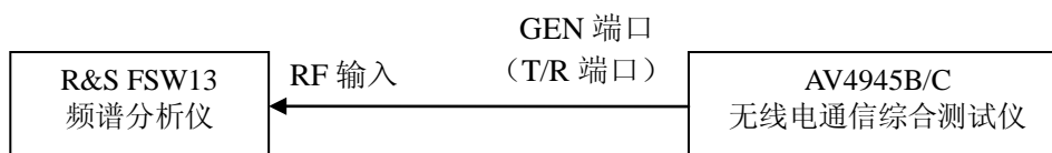
图 6-1 射频信号发生特性测试的框图
