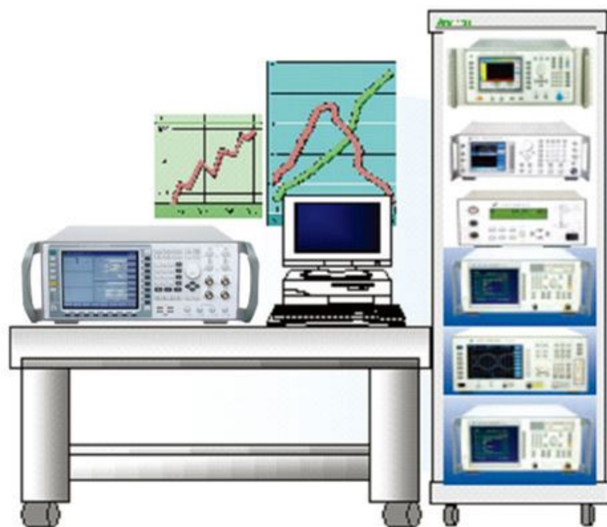
终端射频一致性测试系统搭建图
