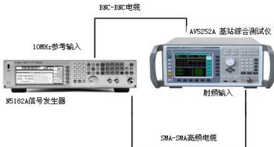
图 2-1 482MHz 自校准信号的连接
