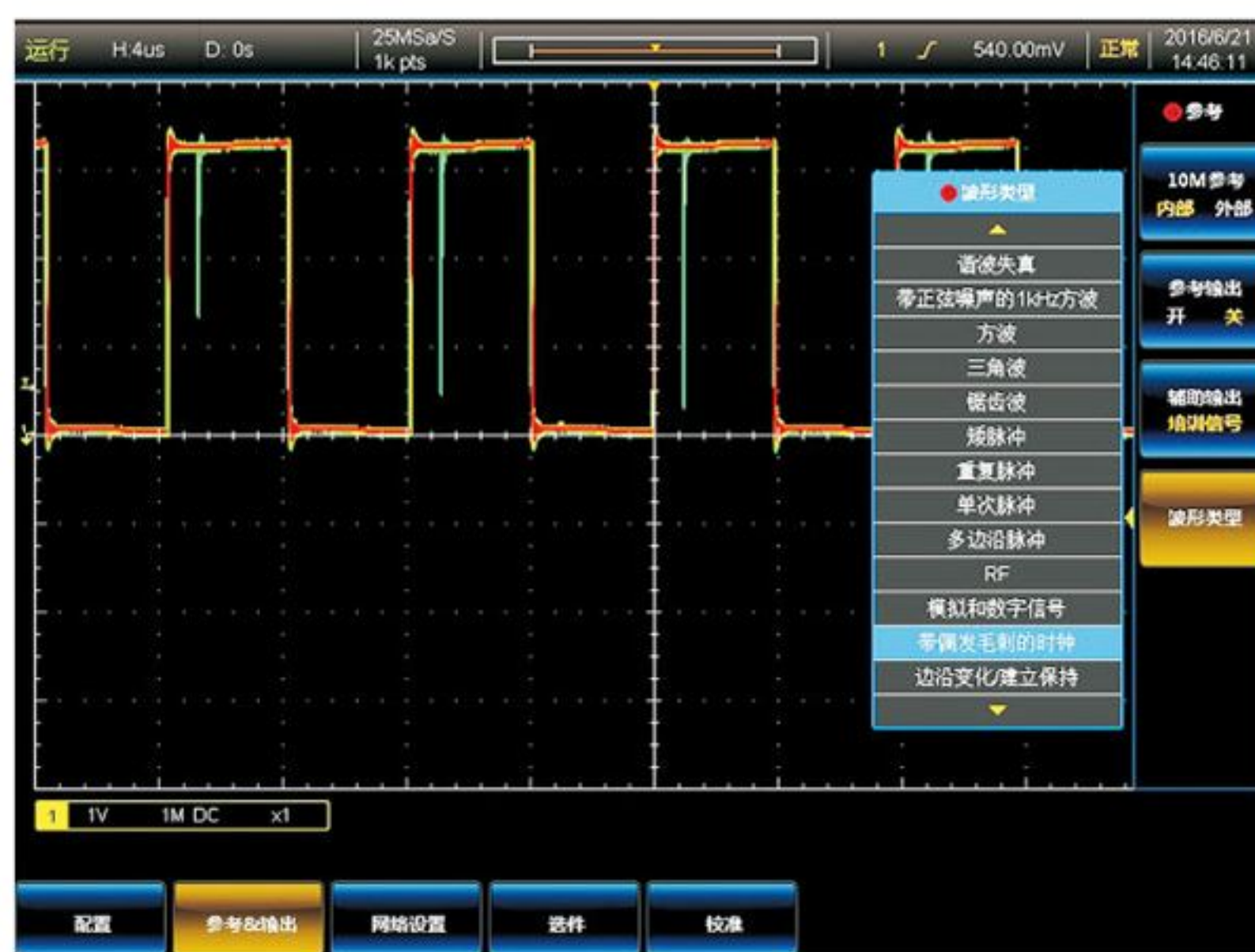
培训信号：带有偶发毛刺的时钟信号
