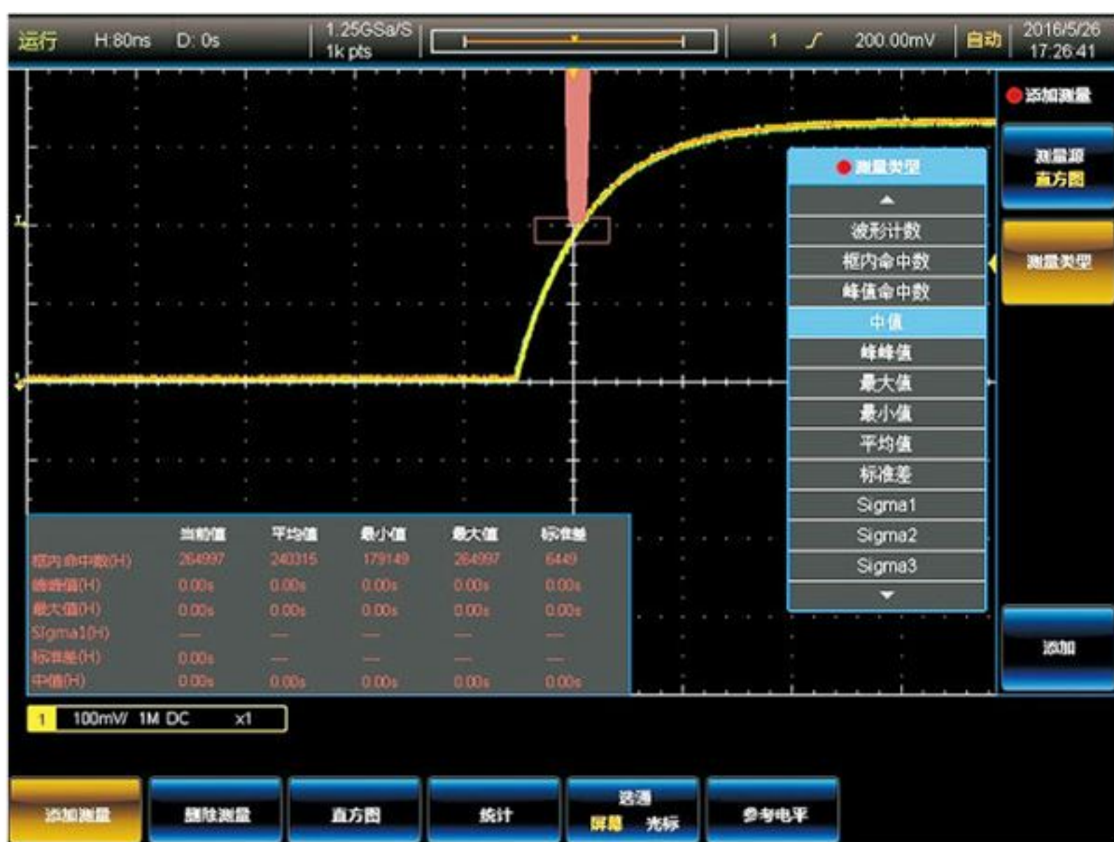
水平直方图：观察信号的抖动及抖动分布
