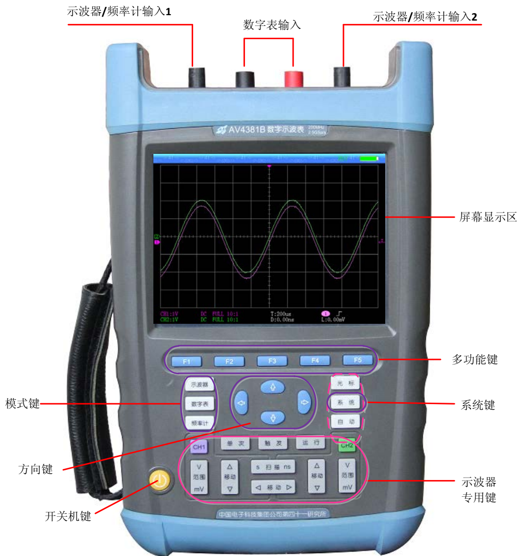
图 2.1 AV4381B 数字示波表前面板
