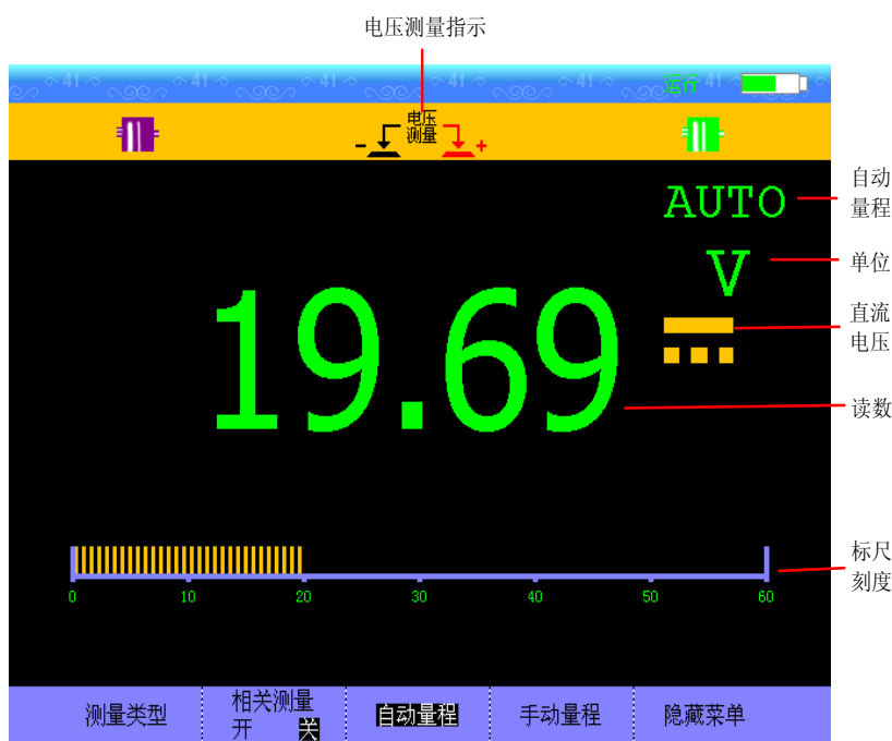
图 4.6 直流电压测量示意图
