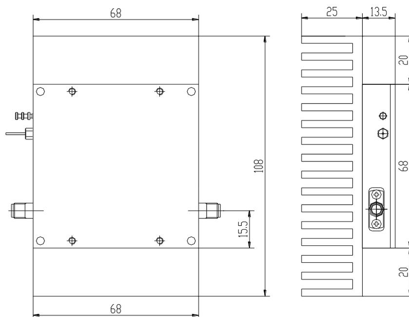
80244 结构尺寸（装配散热器，单位：mm）
