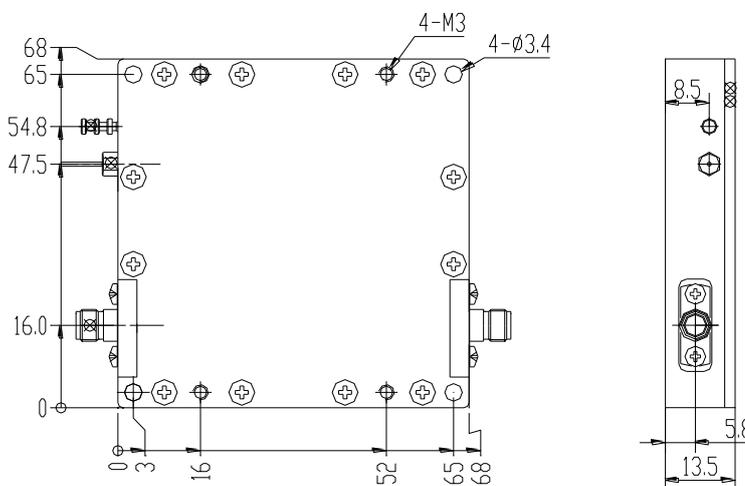
80244 结构尺寸 (不装散热器，单位：mm)
