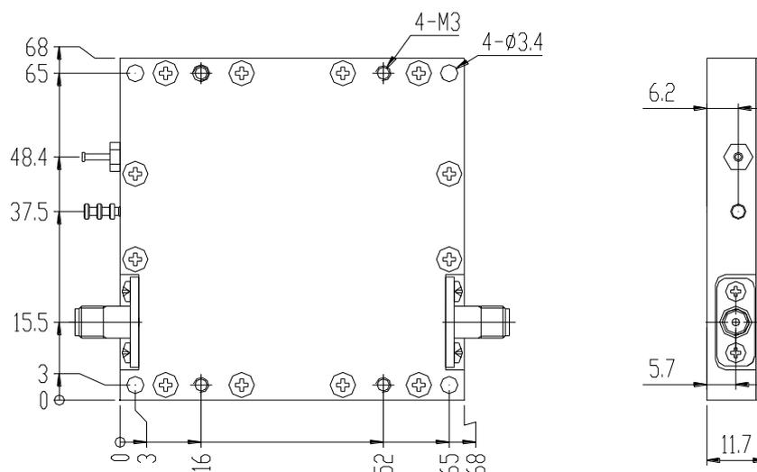
80253 结构尺寸 (不装散热器, 单位: mm)
