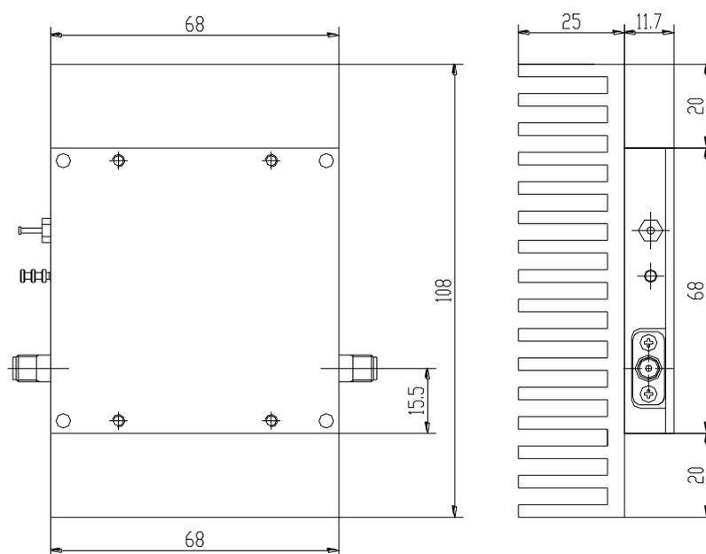
80253 结构尺寸 (装配散热器, 单位: mm)
