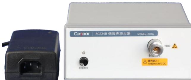
8023XX 系列低噪声放大器既可单独作为低噪声放大器来用，又可与其它测量仪器组成一些重要的测试系统。8023XX 系列低噪声放大器提供低噪声的小信号的放大功能，能够提高系统的动态范围，降低系统的噪声系数，提高接收信号的信噪比和灵敏度，具有广泛的应用。8023XX 系列低噪声放大器包括不同频率、不同输出接口共 7 种类型。
