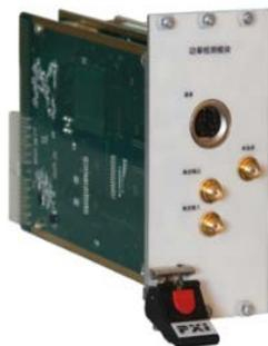
AV6921P 型 PXI 峰值功率分析模块是一款 3U、3 槽尺寸的 PXI 峰值功率分析模块，由主机模块加峰值功率探头组成。可以实现脉冲功率、脉冲频率、脉冲宽度、脉冲周期、脉冲沿等参数的测量，用于测量脉调制信号幅度和时域参数。频率测量范围为 50MHz~18GHz，脉冲功率测量范围为-40dBm~+20dBm。
