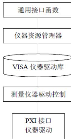
虚拟仪器驱动器的层次结构示意图
