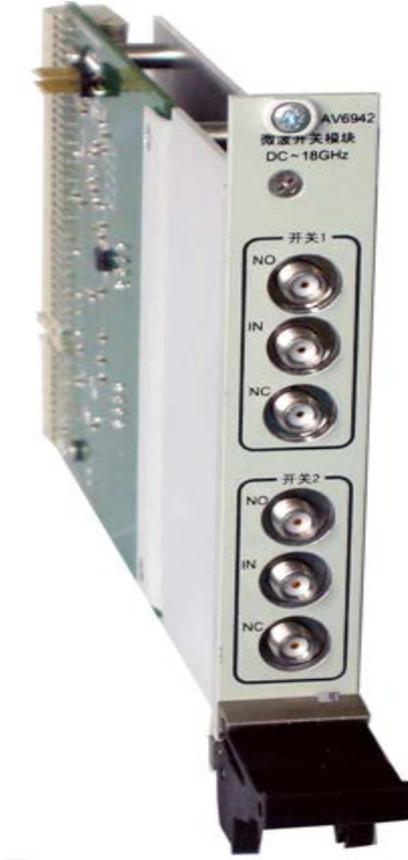
AV6942 PXI 1 选 2 微波开关模块为符合 PXI 总线技术规范的微波通道切换模块，具有插入损耗小、通道驻波比小、开关承受功率大、软件驱动标准规范等特点。该产品可广泛的应用于军用雷达、通信、电子对抗、敌我识别、精确制导武器等多种电子武器装备的自动测试设备（ATE）中，是这些系统中进行微波通道切换必不可少的部分。微波开关模块作为构建微波通道的基本模块，是组成 PXI 总线自动测试系统必不可少的基本模块。
