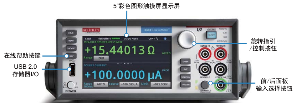
2450型仪器前面板, 包括高分辨率电容触摸屏
