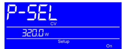
3. 在用左旋钮调节功率值（单位为W），方法跟电压调节一样。粗调与精调的转换跟上面一样。如果直流输出已打开，则调节值立即生效。
