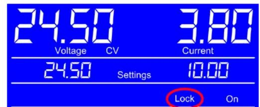
锁定状态一直会显示，直到使用按钮解锁后方消失。即使用户将产品转为远程控制并返回本地操作，或者关闭产品也不会消失。关闭产品时不会保存锁定功能。
