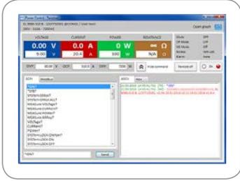
本产品还配有适合Windows系统下操作的控制软件，叫做EA Power Control。它可远程控制多台同型号产品，甚至不同型号产品。它有一个清晰的主界面，显示所有设定值与实际值，SCPI与ModBus RTU指令的直接输入模式，固件升级特性，以及被称为“排序”的半自动化控制表格。其它特征还可通过购买注册码进行解锁：
