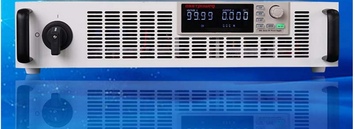
KSL 系列通用型（普及推广型）直流电源是我公司为了满足广大客户的需求推出的一款高品质低价位的超高性价比产品，10KW 的功率密度仅 2U 尺寸，电压最高可到 2000V，电流最大可到 400A，是需要宽范围输出电压或电流范围调节应用的理想输出，具有定电压和定电流两种工作模式。可以应用在自动测试，过程控制，电池充电及老化测试等需要高质量直流稳定电源的产场合，本系列产品具有零电压“软开关”功能，可实减小开关瞬变应力，从而具有很低的输出噪声。软开关也可以提高效率，减小热量，从而使电源具有更高的稳定性。
