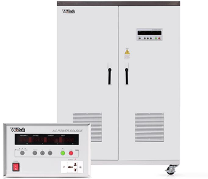
HY8L 系列变频电源，以微处理器为核心，面板使用按键操作，可预先设定电压、频率。以先进的 SPWM 方式制作，用功率原件 IGBT 模块设计，采用了数字分频、D/A 转换、瞬时值反馈、正弦脉宽调制技术，以隔离变压器输出来增加整机稳定性，具有负载适应性强、输出波形好、操作简便、体积小、重量轻等特点，具有短路、过流、过载、过热等保护功能，以保证电源可靠运行。
