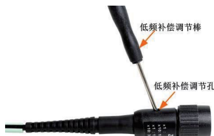
图 5.7 探头补偿调节孔
