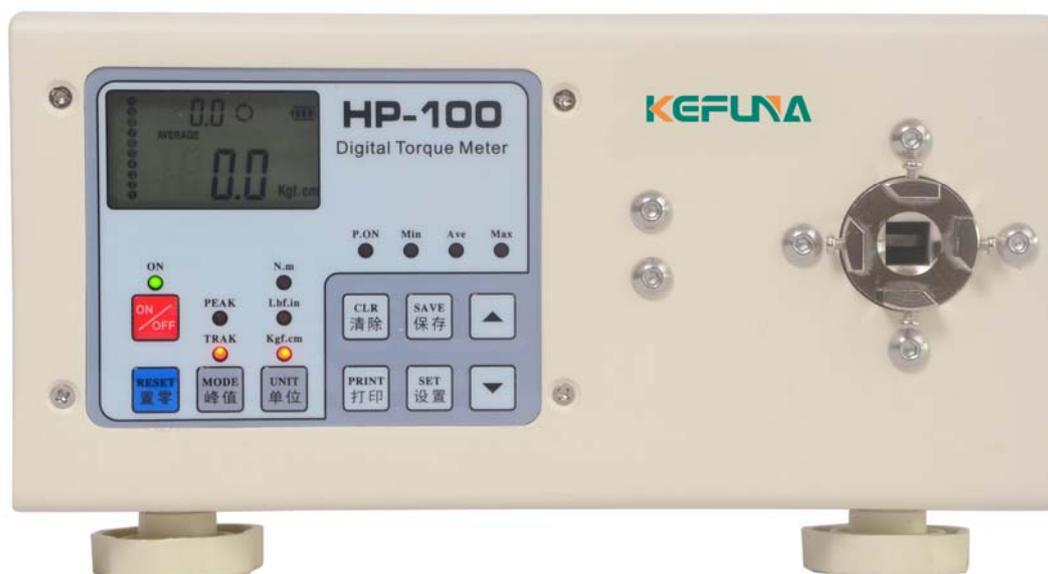
HP 系列数字式扭力测试仪是为检测各种扭矩而设计制造的一种智能化计量仪器。主要用于计量校准各种电动螺丝刀、气动螺丝刀、扭力起子和扭力扳手扭力的大小，还可用于检测电机、马达、瓶盖、玩具、灯头的扭力，使之符合生产需要，以及各种产品和零件的旋转性破坏试验等。
