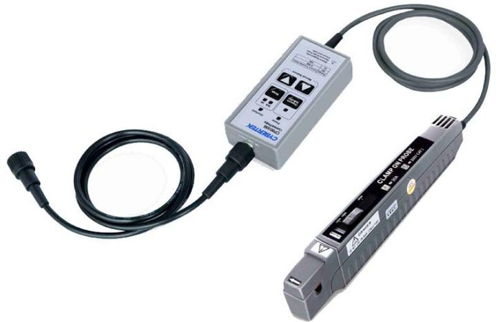
CP8030B/H 体积轻巧，可在当前拥挤的电路板中使用自如；小型钳夹可以在紧张的空间中探测电流，同时仍能夹住直径达 5mm 的导线；可以测量 30A 的连续电流和 50A 的峰值电流，CP8030B 提供 50MHz 的带宽,CP8030H 提供 100MHz 带宽；探头具有 30A (10X)和 5A (1X)两个量程可选择，5A (1X)量程特别适用于小电流测量，分辨率高达 1mA。
