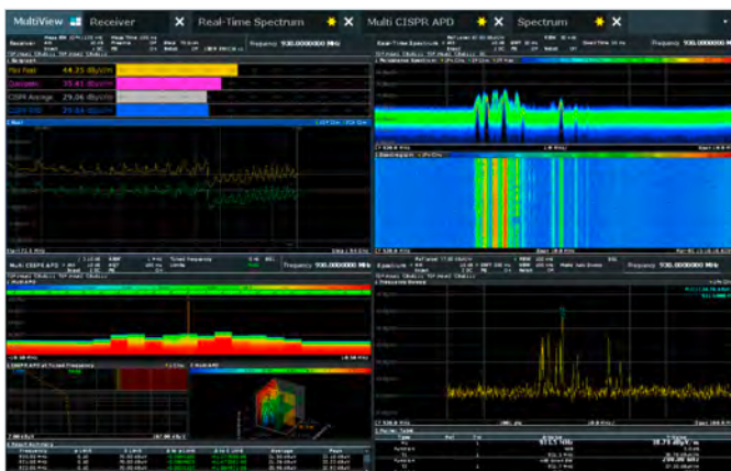
包含柱状图、扫描的射频频谱、中频分析和瀑布图的多视图显示。
