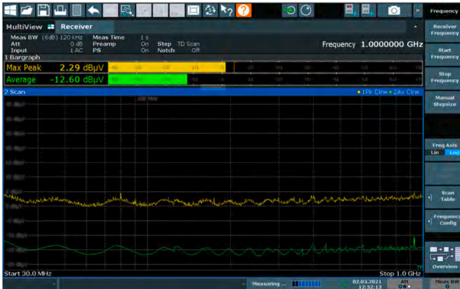
频率达 1 GHz 时的显示平均噪声电平 (DANL)。开启前置放大器时的噪声系数约为 8.5 dB。
