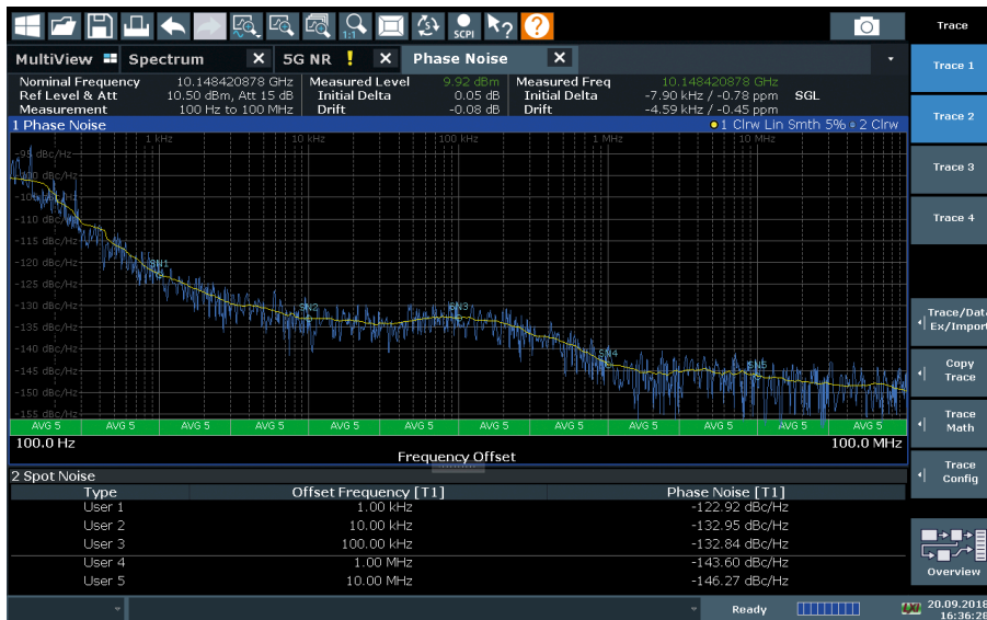
10 GHz 载波、10 kHz 载波偏置时的相位噪声：典型值 -133 dBc (1 Hz)
