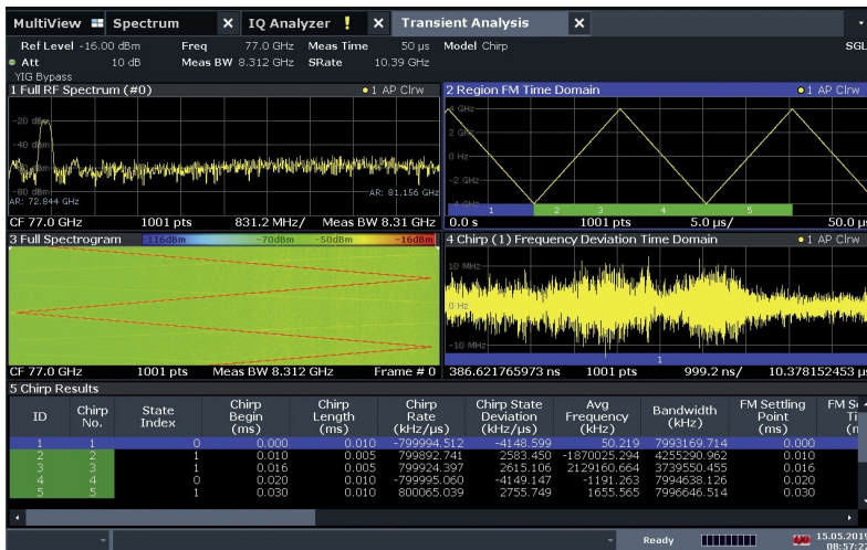
使用 R&S®FSW-K60C 选件和 8.3 GHz 分析带宽分析 FMCW 信号
